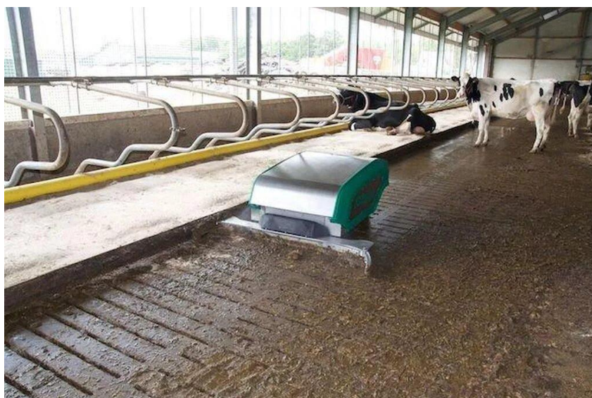
Рис. 1. Роботизированный скрепер для удаления навоза SRone
