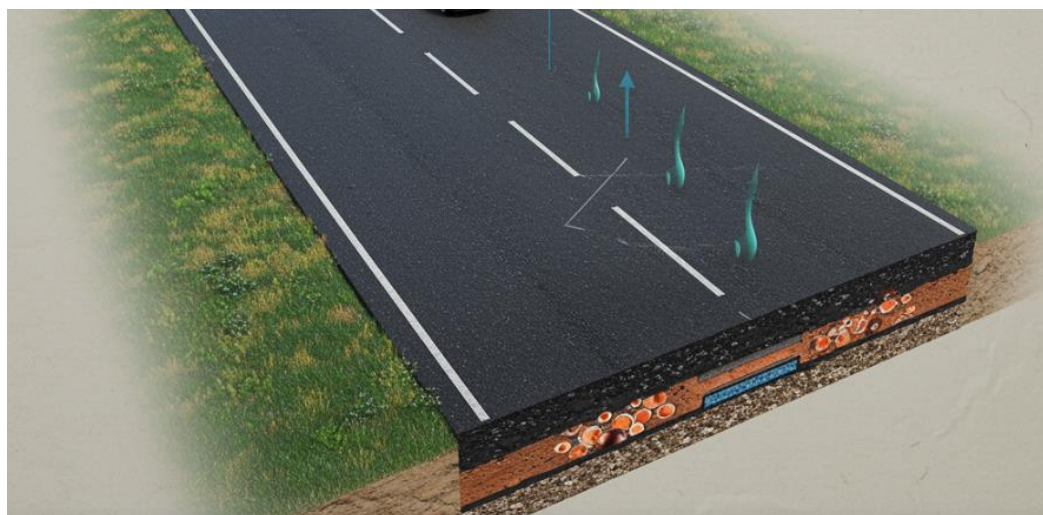
Рис. 1. Инновационное дорожное покрытие с диоксидом титана
