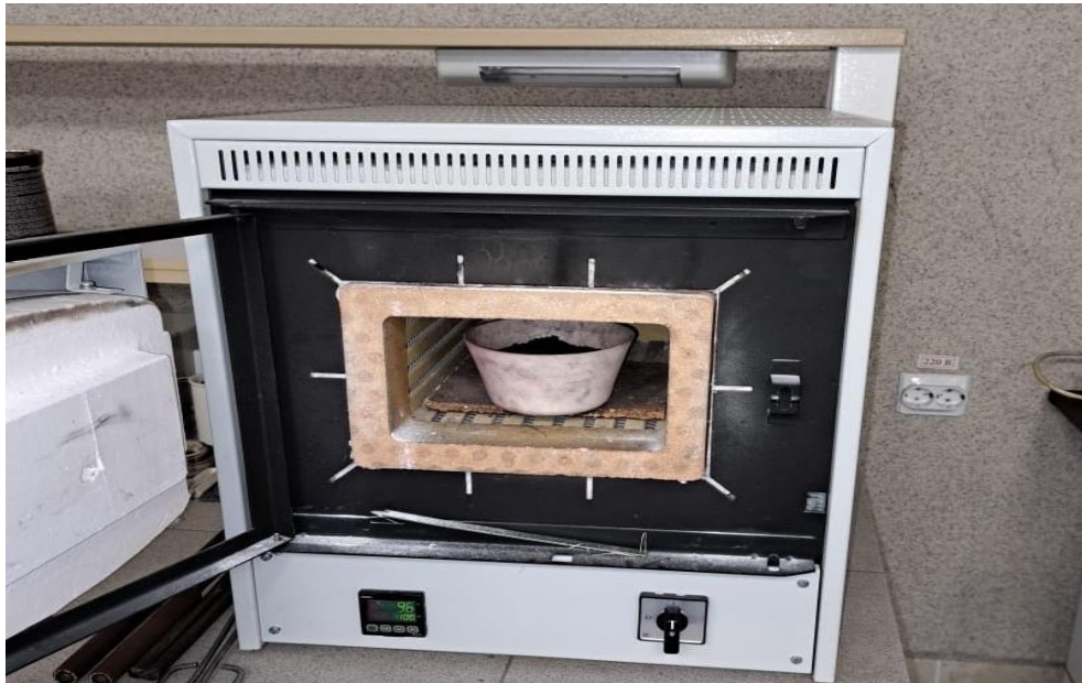
Рис. 1. Процесс сушки шлама в муфельной печи
