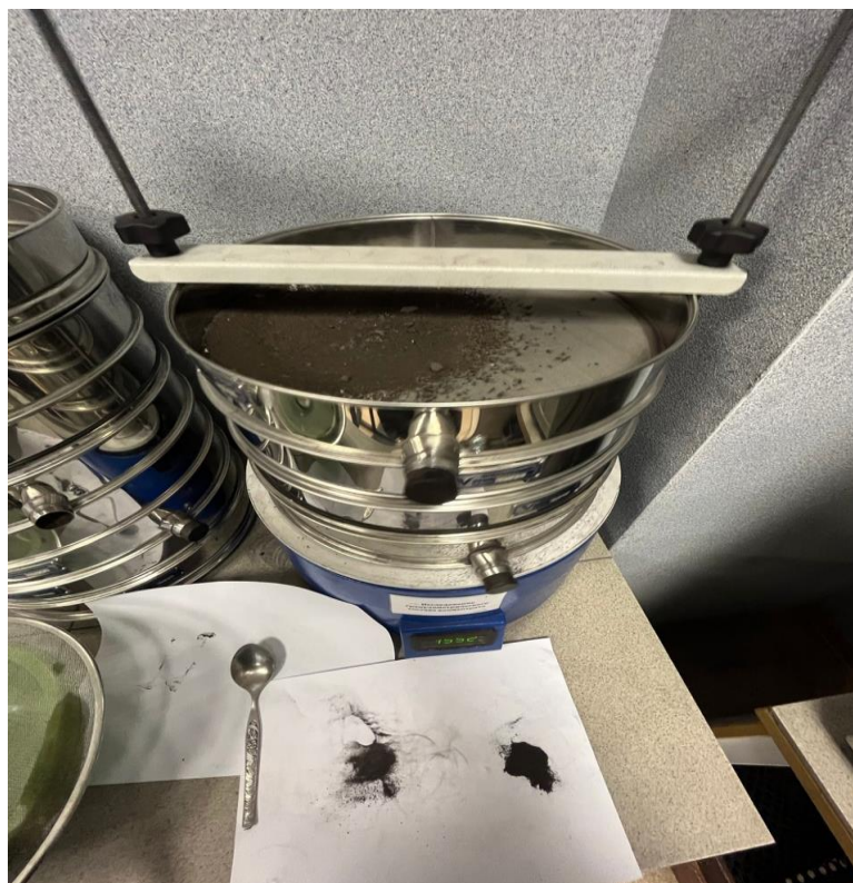
Рис. 2. Процесс просеивания шлама на вибросите
