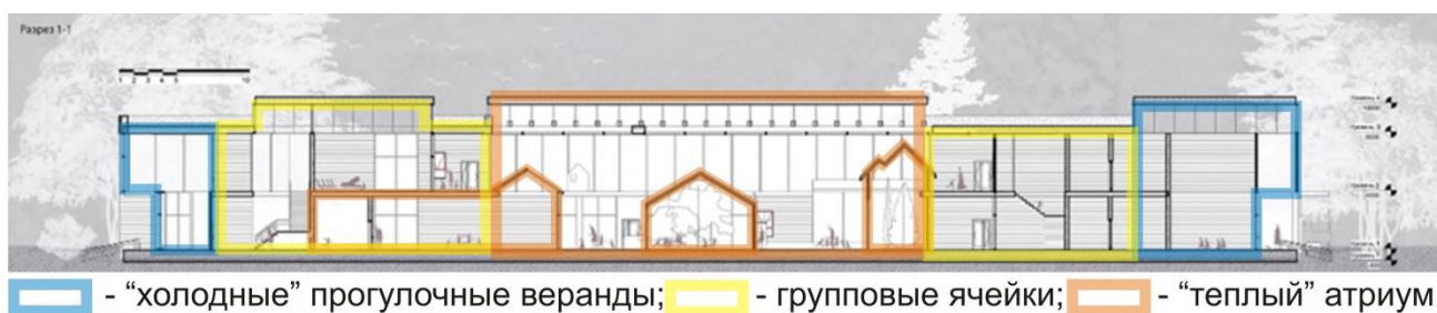
Рис. 6. Фрагмент курсового проекта. Дошкольное образовательное учреждение в Нягани. Разрез ДОУ.
