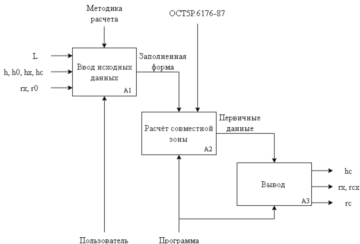
Рис. 5. Расчёт зоны защиты двойного тросового молниеотвода
