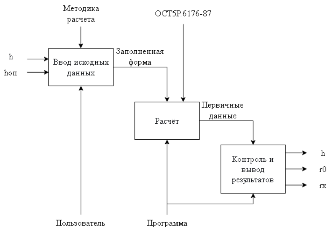
Рис. 4. Расчет зоны защиты одиночного тросового молниеотвода
