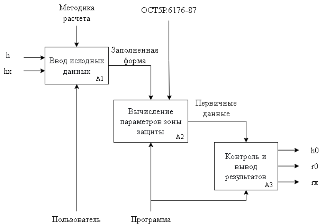
Рис. 1. Расчёт зоны защиты одиночного стержневого молниеотвода
