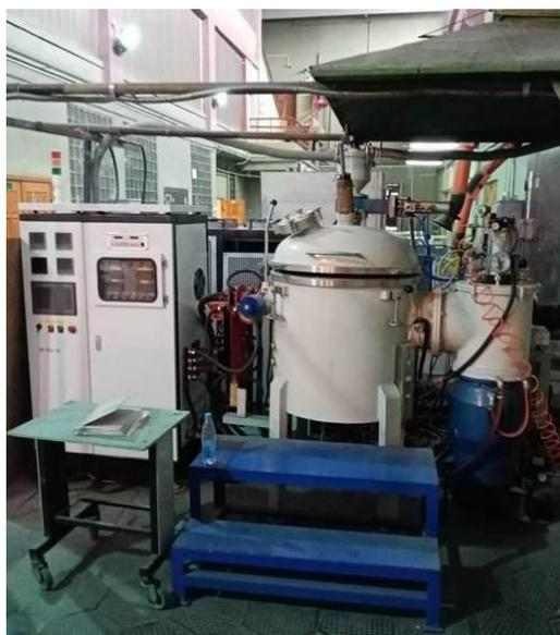
**Рис. 2. Вакуумная 10 килограммовая индукционная плавильная установка фирмы Zhengzhou Brother Furnace Co., Ltd**
