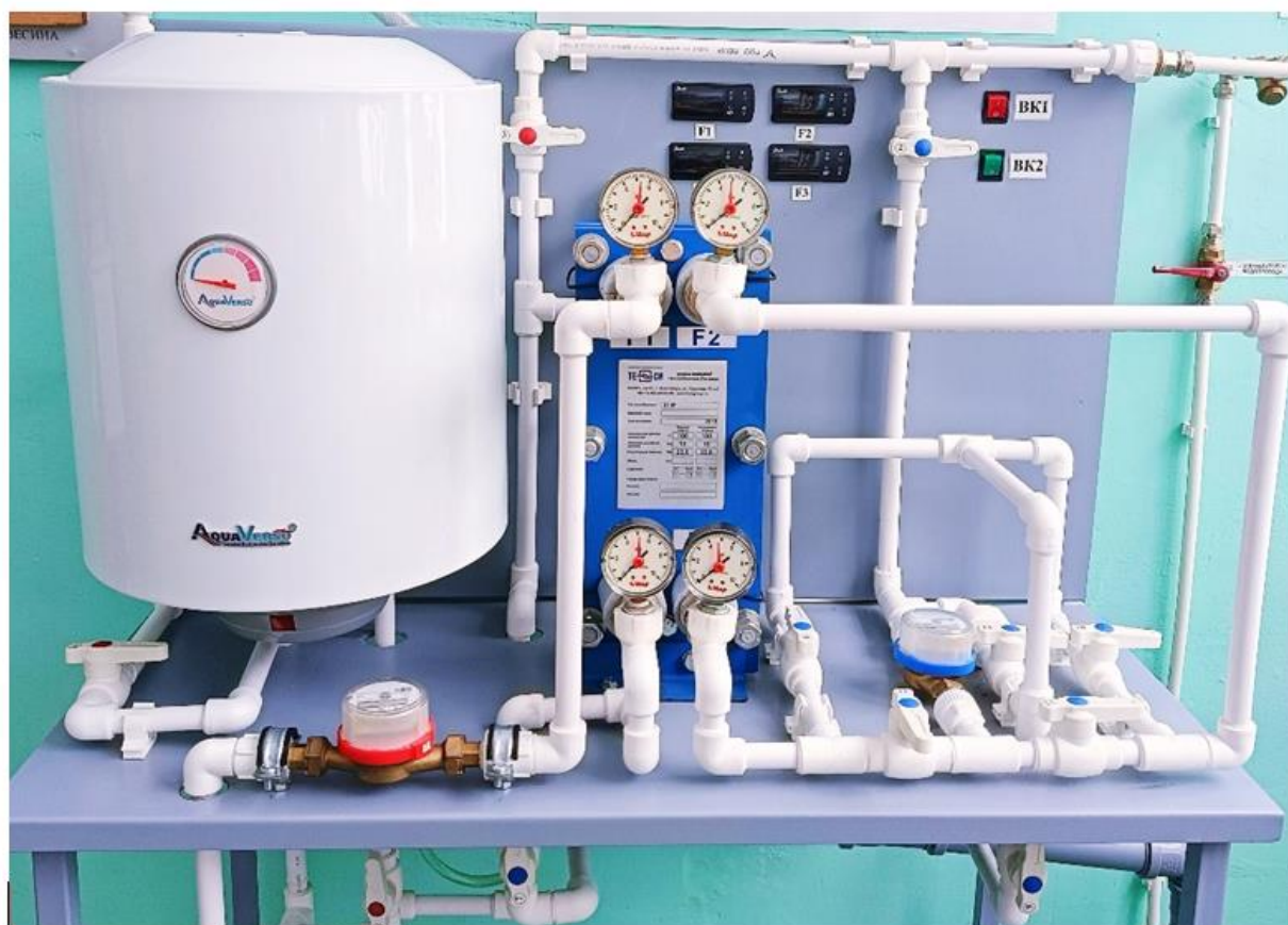
Рис. 2. Лабораторный стенд пластинчатого теплообменного аппарата
