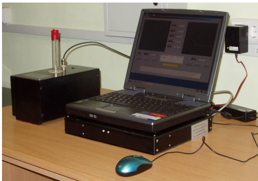
Рис. 1. Портативный переносной с питанием от 12 В аккумулятора релаксометр ПМР
