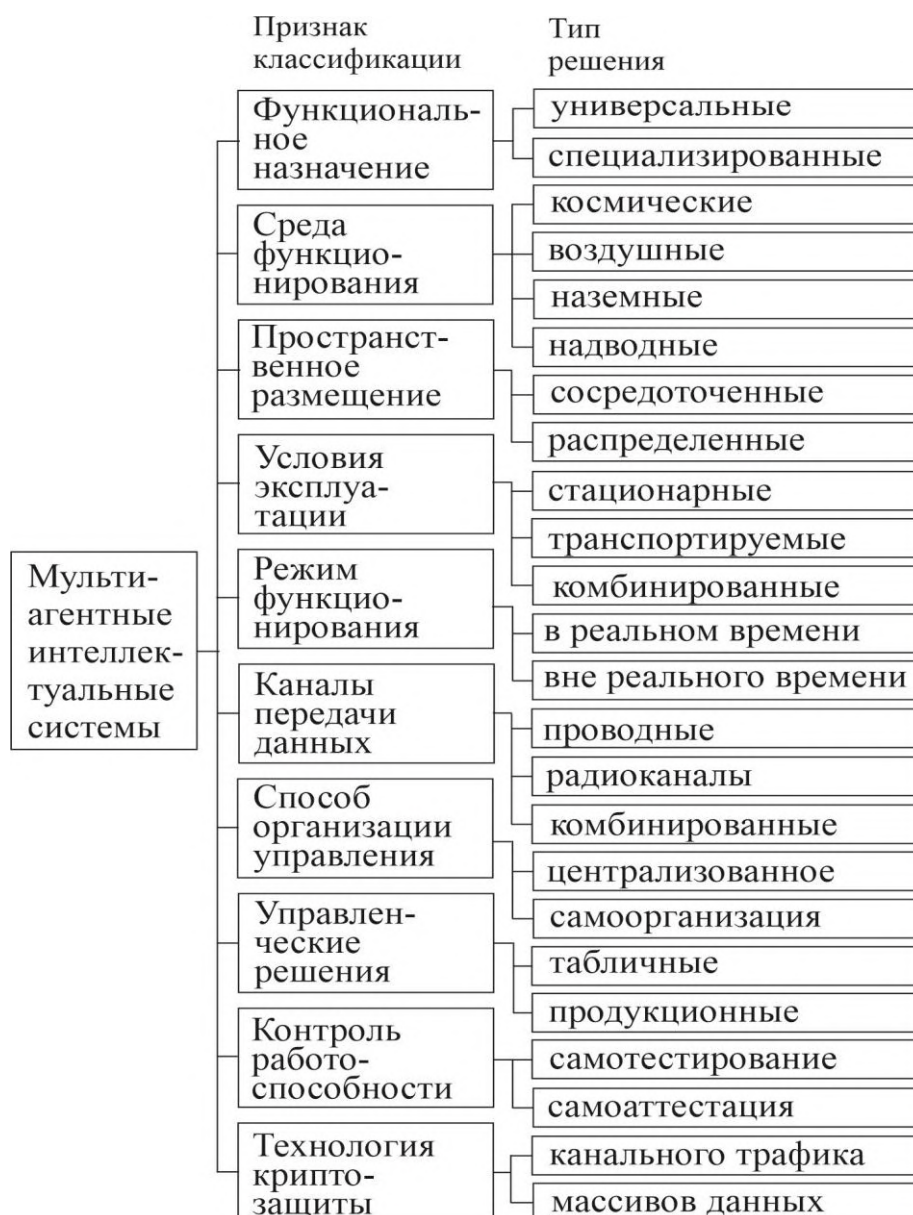
Рис. 1. Схема классификации признаков мультиагентных интеллектуальных систем широкого спектра назначения
