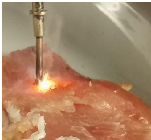
Рис. 12. Разряд между рабочим инструментом и БТ
