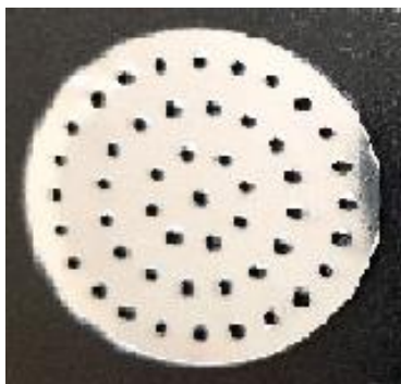
Рис. 5. Фотографический вид с фронтальной стороны плавучего испарителя солнечного опреснителя воды
