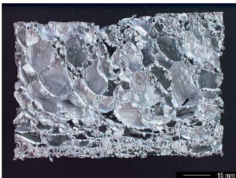
Рис. 2. Формирование различной пористости по толщине при неравномерном распределении реагента
