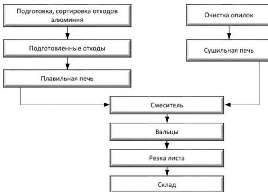
Рис. 8. Схема технологического процесса получения листового вспененного материала
